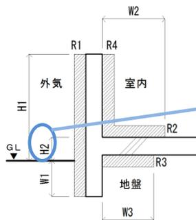
底盤高とは、設計GLから基礎底盤上端までの高さのこと。
