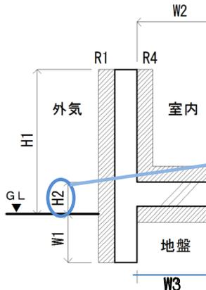
底盤高とは、設計GLから基礎底盤上端までの高さのこと。
